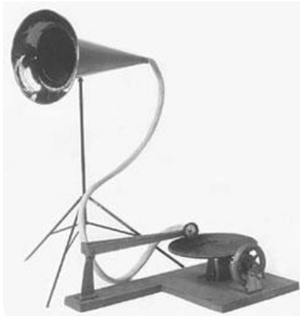
Prototipo di grammofono realizzato da E. Berliner - 1887
