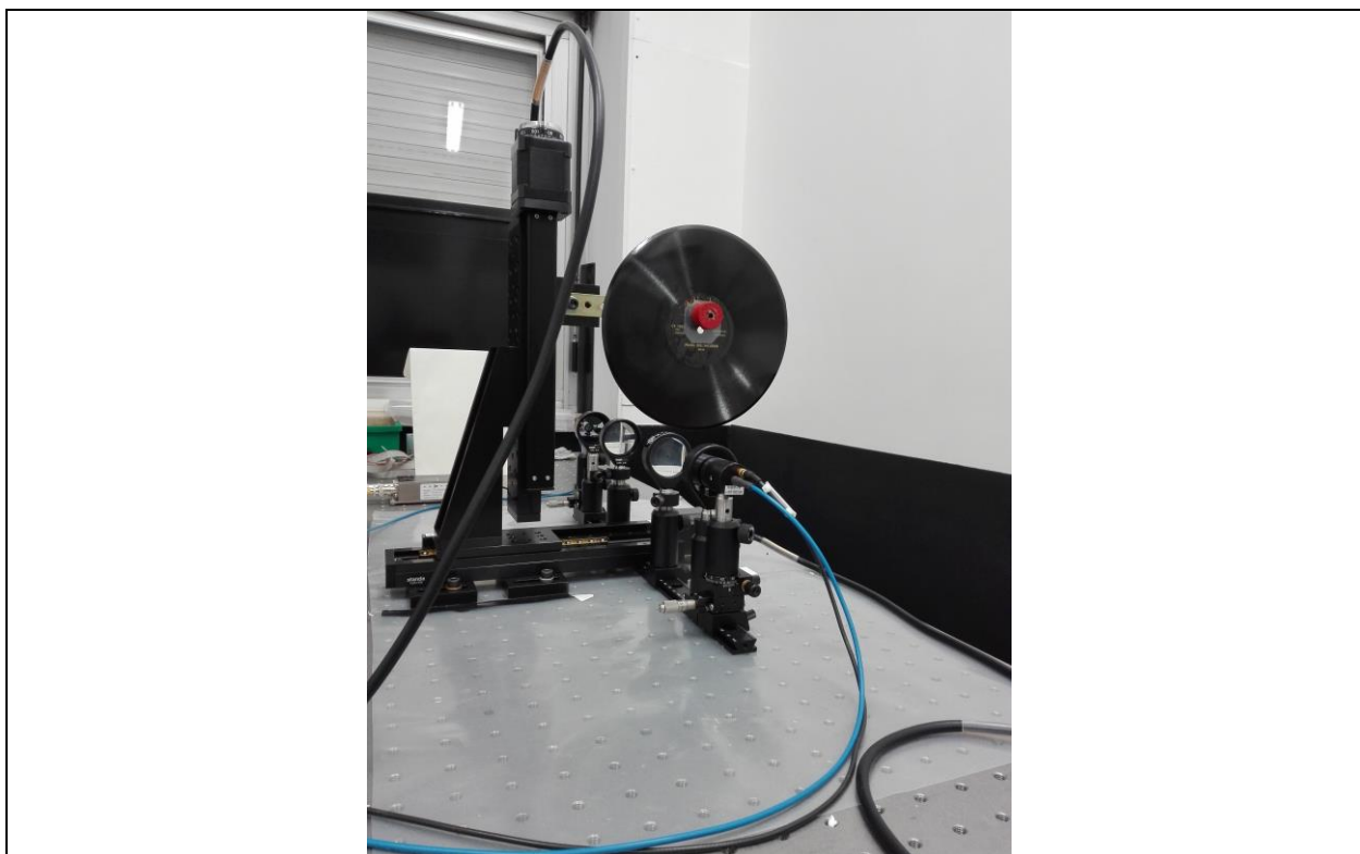
Un disco Durium montato sul sistema di scansione per le immagini ad onde THz prima della misura.
